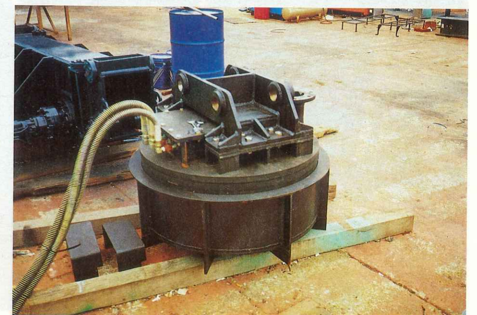
ドラム吸引機。先端の羽根が低速で回転し（1分間に10回転以下、正逆とも回転可能）、たい積層を破碎しながら汚泥を吸引する。径150mm程度の吸引口が底面に1カ所あり、汚泥以外のものを吸引しないように30mm角のメッシュが付いている
