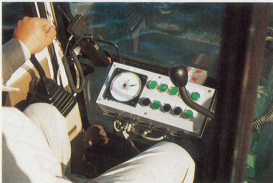
バックホーの運転席にある操作盤。各作業装置の操作機能をまとめて配置してある
