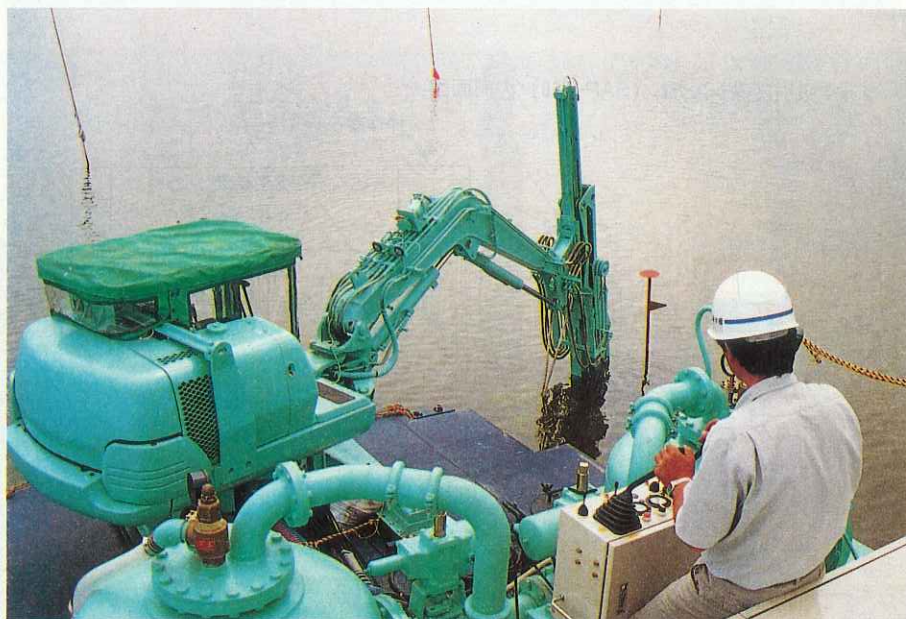
遠隔操作システム。リモートケーブルにより、50mまでの遠隔操作が可能だ
